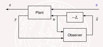
$$\begin{cases} \frac{dx(t)}{dt} = Ax(t) + Bu(t) + Nv_1(t) \\ y(t) = Cx(t) + v_2(t) \end{cases}$$
