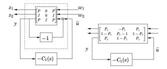
$$G_{zw}(s) = egin{bmatrix} P_c & -P_c \ 1-P_c & P_c-1 \end{bmatrix} + egin{bmatrix} P_c \ 1-P_c \end{bmatrix} Q \begin{bmatrix} P_c & 1-P_c \end{bmatrix}$$
